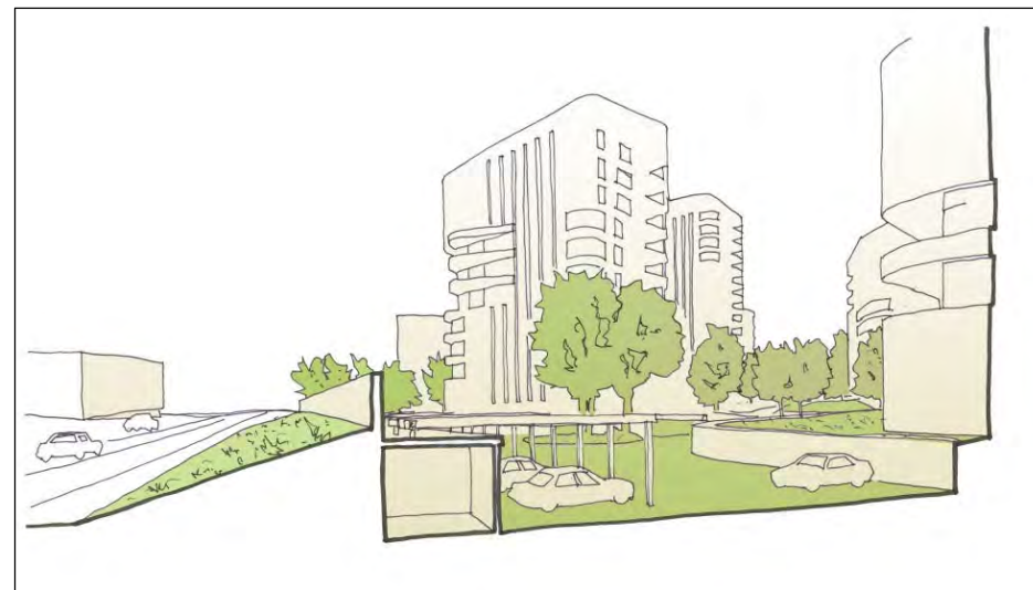
Parkeren en bergingen achter een talud
